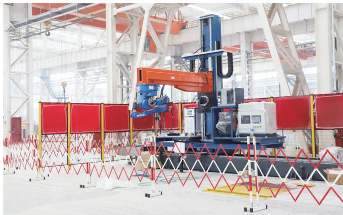
8月23日,起重分公司大筋板机器人焊接工作站正式进入调试阶段,标志着太重新园区向着智能化迈进。
